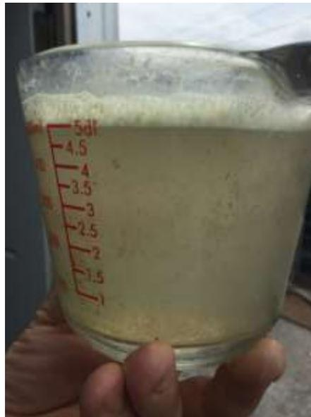
*Fig. 4 : Eau clarifiée à la sortie de la centrifugeuse*
