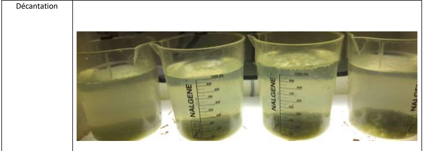
Ce 2<sup>nd</sup> Jar-test confirme qu'un dosage de 0,3 mL/L du AQ-8921 en combinaison à un dosage de 35 mg/L du polymère en émulsion AQ-8561 permet un abattement de 97% de la turbidité initiale.
