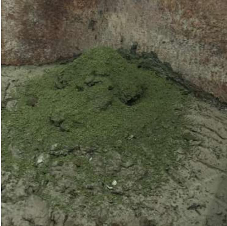
*Fig. 5 : boues produites à la sortie de la centrifugeuse*
