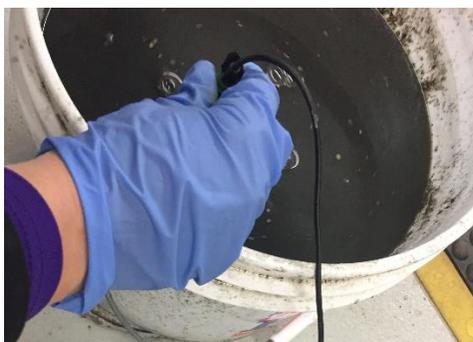
Fig. 2 Chaudière de boues de fosses septiques sur lesquelles ont été effectués les tests (pH : 7,3)
