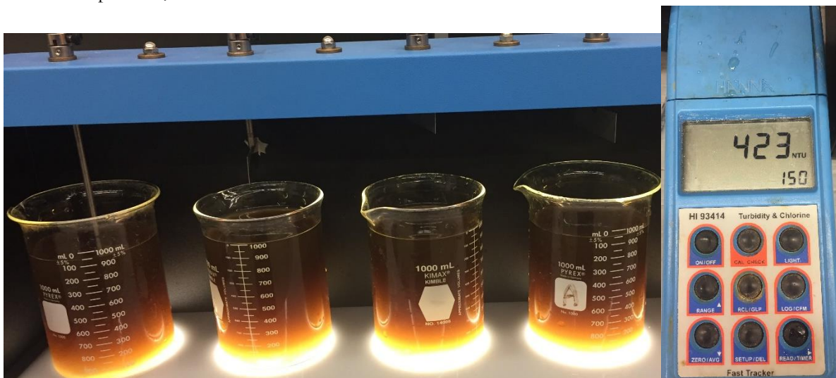
Figure 1. Eaux brutes de la 1ere chaudières d'eaux de lixiviation et turbidité initiale
