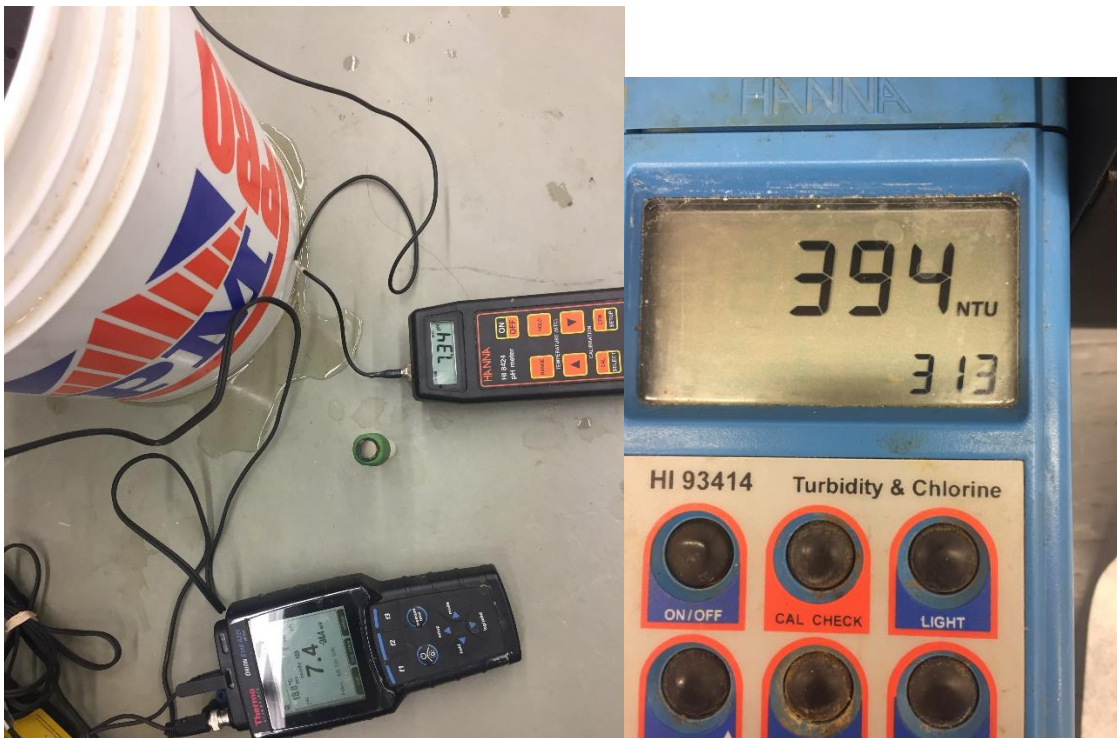
Figure 2. pH et turbidité des eaux usées de la 2 nd chaudière
