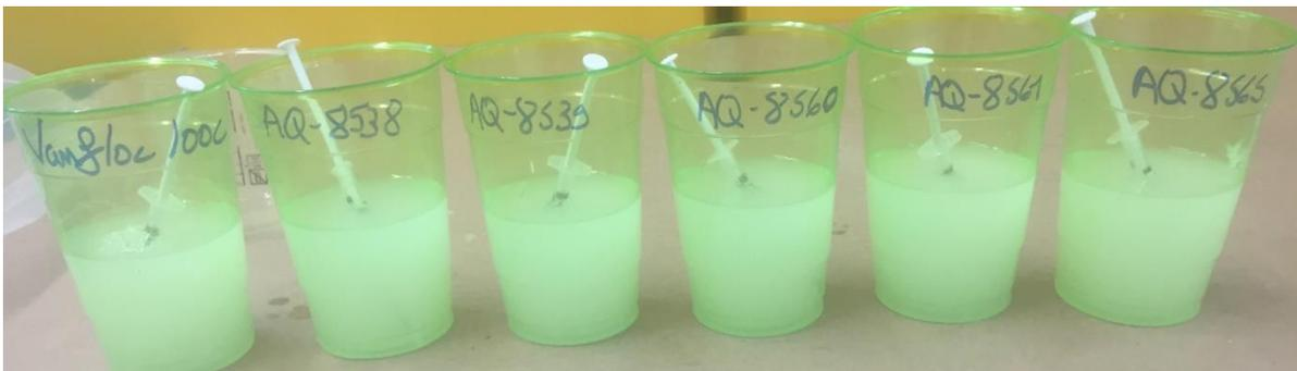
*Fig. 1 Solution à 5g/L des polymères testés*
