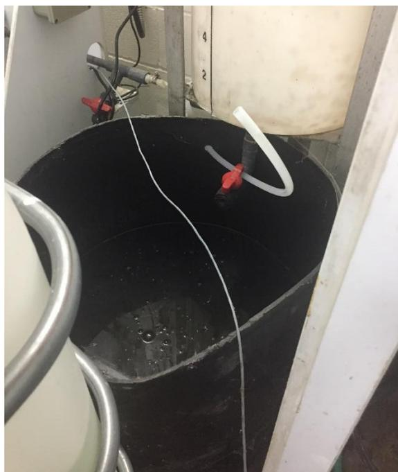
Fig. 3 : Réservoir dans lequel j'ai prélevé la solution de polymère AQ-8116
