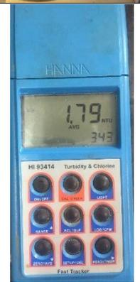
Il est nécessaire en ce moment de doser au minimum 3 mL/L de sulfate ferrique AQ-8810 pour obtenir une eau clarifiée avec une turbidité inférieure à 20 NTU en usine (donc pouvant respecter la norme de sortie en MES de 35 mg/L). En jar-test les résultats obtenus sont souvent meilleurs qu'en usine pour les mêmes dosages de chimiques car notre mélange coagulant/eaux à traiter et polymère/eaux à traiter est parfait.
