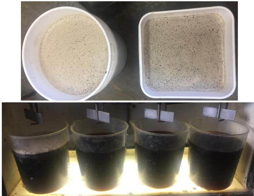
*Figure 1 et 2. Chaudières d'eaux brutes du lixiviat échantillonnées par Nicolas- présence visible de bulles d'air dans les eaux échantillonnées - Eaux brutes dans les béciers du Jar-tester (eaux très noires)*
