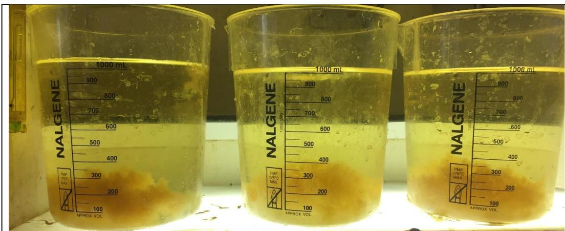
Comparaison des deux anioniques (AQ-8116 à gauche versus AMX 239 à droite)
