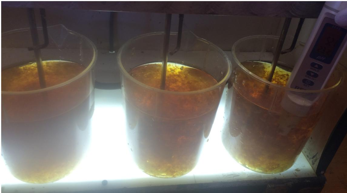
*Fig 1. Courbe de coagulant AQ-8810 de 1000  $\mu\text{L/L}$  à 2000  $\mu\text{L/L}$  avec le polymère AQ-8117 à 6 mg/L*
