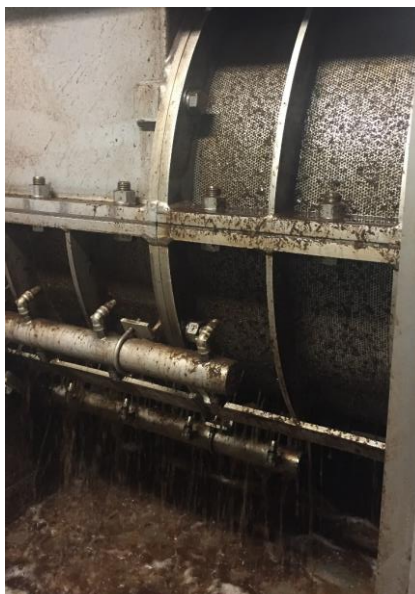
Fig. 1 : Pores de la presse à vis. Celle-ci avait été nettoyée en profondeur la veille de ma venue à la suite de problèmes de colmatage des pores
