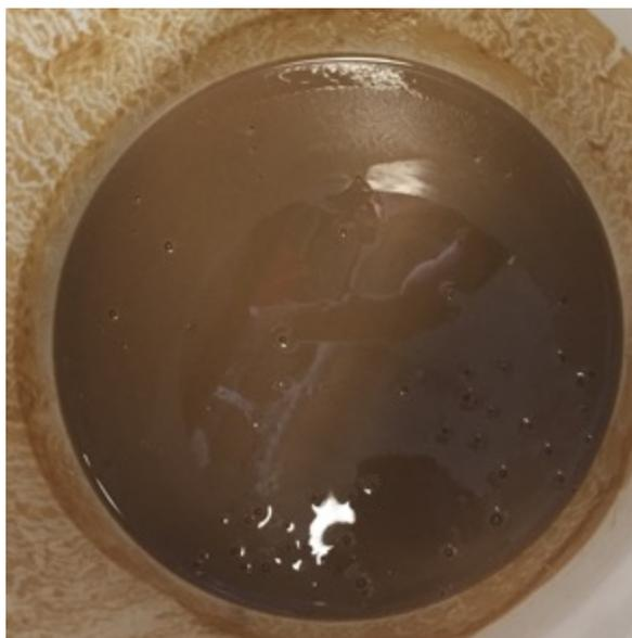
Fig. 4: Chaudières de boues du Multiflow sur laquelle nous avons effectué nos tests- ces boues sont épaisses.
