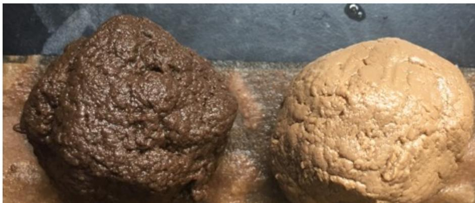
*Fig. 5 : Boues flocculées avec le polymère AQ-8218 et compressées par la suite entre nos gants- Gauche boues du RBS droite boues du Multiflow*
