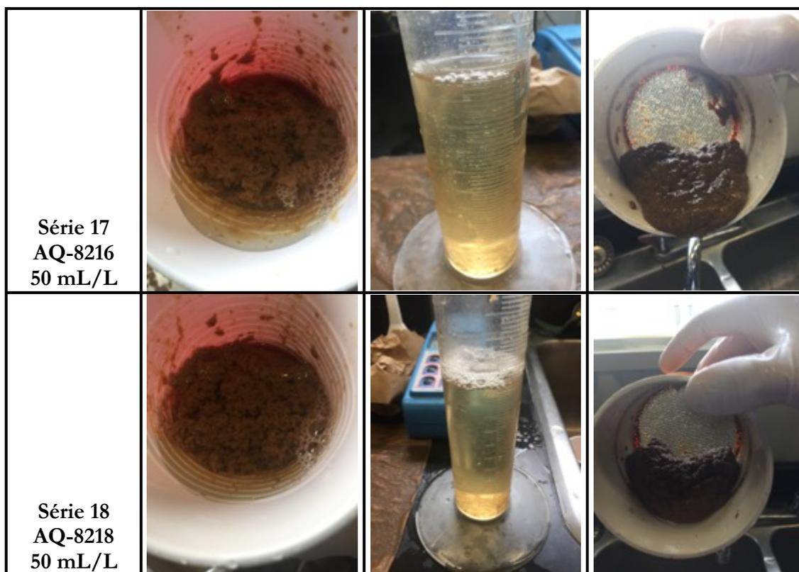
*Figure 4. Flocculation des boues du Multiflow avec les 4 polymères sélectionnés*
